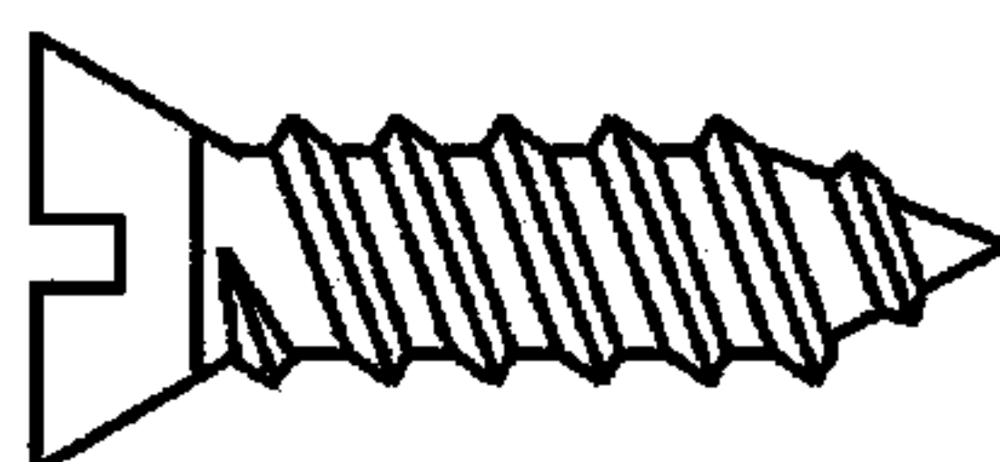
图 28 螺纹成型自攻螺钉(见 3.19)
